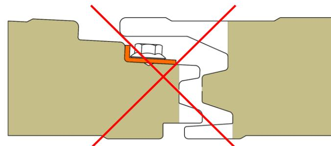
N'oubliez pas de veiller au bon serrage des vis, car un serrage excessif risque de déformer le joint et de provoquer des imperfections.
