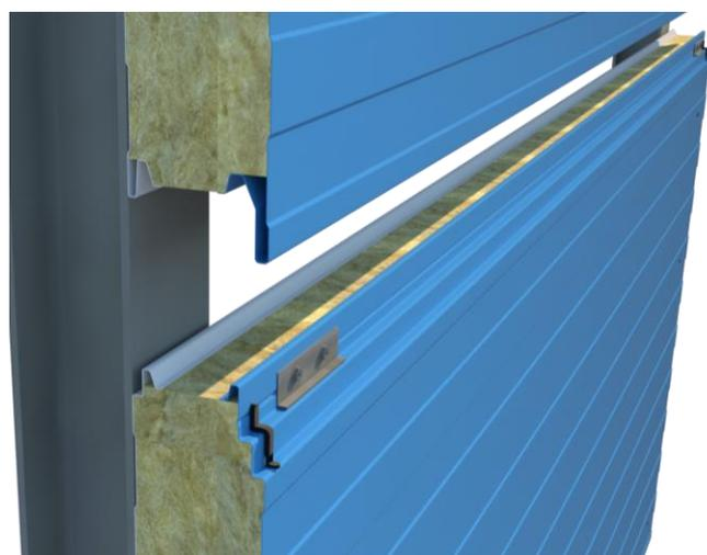
Vérifiez que le panneau est parfaitement horizontal et fixez-le avec des vis traversantes aux montants structurels le long des deux extrémités du panneau et ensuite près du joint mâle en plaçant une plaque de répartition en acier entre les vis et le panneau. Les vis doivent être de longueur appropriée (voir le paragraphe sur l'installation verticale).
