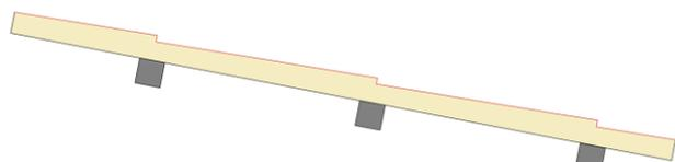
Coupe transversale d'un panneau MB COPPO dans laquelle il est possible de voir le pas des tuiles à 350 mm.
