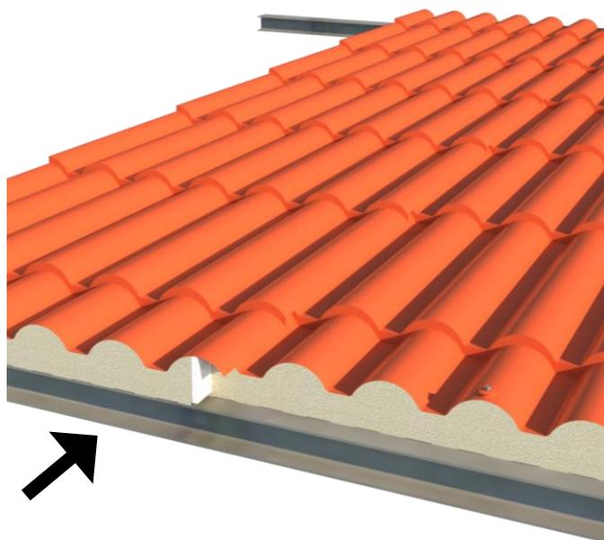
Une fois le panneau positionné, il convient de le pousser de manière à ce qu'il soit aligné avec le panneau déjà fixé, afin d'obtenir un bon ajustement des tuiles au niveau de la différence de hauteur entre les tuiles. Exercez ensuite une force latérale pour vous assurer que les panneaux sont bien serrés.
