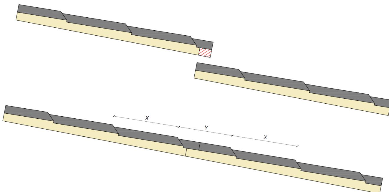
Méthode de chevauchement impliquant l'enlèvement d'une portion limitée de mousse de polyuréthane à la tête du panneau en amont qui est chevauché avec le panneau en aval.
