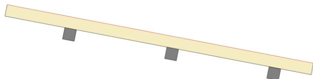
Coupe transversale d'un panneau MB OMEGA qui se distingue du précédent par un profil continu sans dénivelé.
