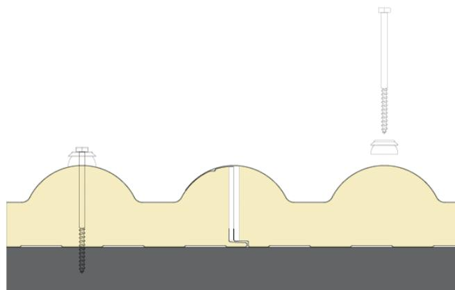
Fixation des panneaux à l'aide de vis de taille appropriée et de joints EPDM interposés entre la tête de la vis et le panneau.
