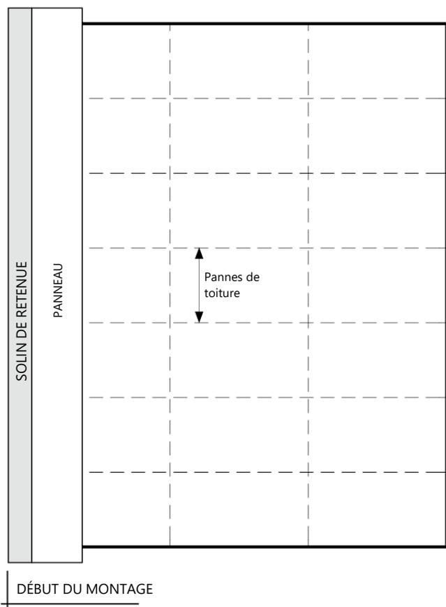
Une fois le point de départ déterminé avec soin et après avoir vérifié les alignements par rapport aux charpentes, il est possible de poser le premier panneau de la toiture, en **suivant le sens de montage** prévu.
