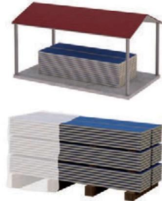
**En cas de non-observation de ces règles, on court le risque de voir l'humidité stagnante attaquer le revêtement et le détacher du substrat galvanisé, ce qui provoquerait l'apparition de « cloques ». Il est conseillé d'utiliser les panneaux dans le mois qui suit leur livraison sur le chantier.**
