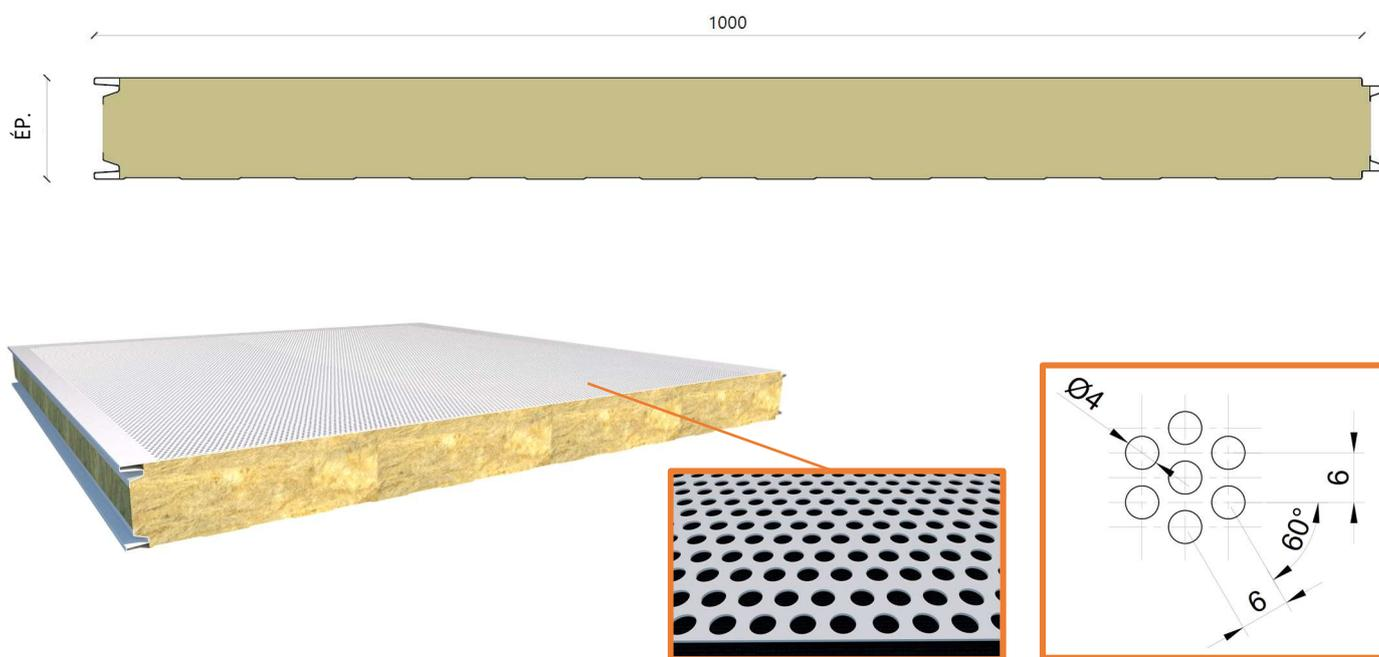
Pour augmenter les propriétés acoustiques, le support métallique sur le côté interne des panneaux est percé de trous de 4 mm de diamètre (R4T6), disposés en triangle avec espace réciproque de 6 mm pour générer une disposition périodique.
