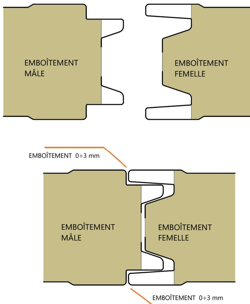
L'emboîtement mâle - femelle visible créé par Marcegaglia Buildtech prévoit l'utilisation d'un système de fixation à la structure métallique (définie en phase de conception) avec des vis sélectionnées convenablement.
